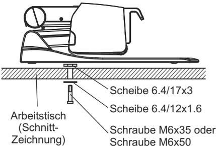
Der Visualizer kann mit der mitgelieferten Tisch-Fixiereinheit an einem Tisch festgeschraubt werden um das Risiko eines Diebstahls zu minimieren. Bitte beachten Sie, dass die nutzbare Gewindetiefe 8mm beträgt - Schraube nicht weiter eindrehen.
