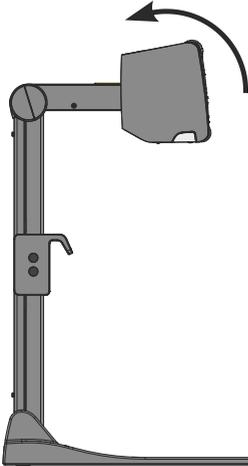
3. Arm mit der Ziehvorrichtung nach oben ziehen (#11).
